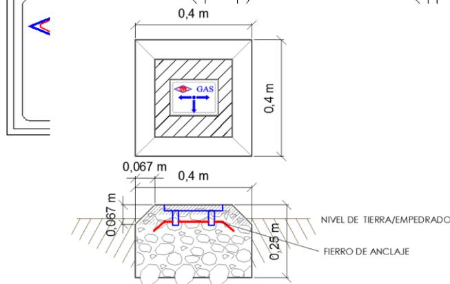
**PLAQUETAS DE SEÑALIZACIÓN HORIZONTAL EN COBERTURAS DE ACERA DE HORMIGÓN.**
