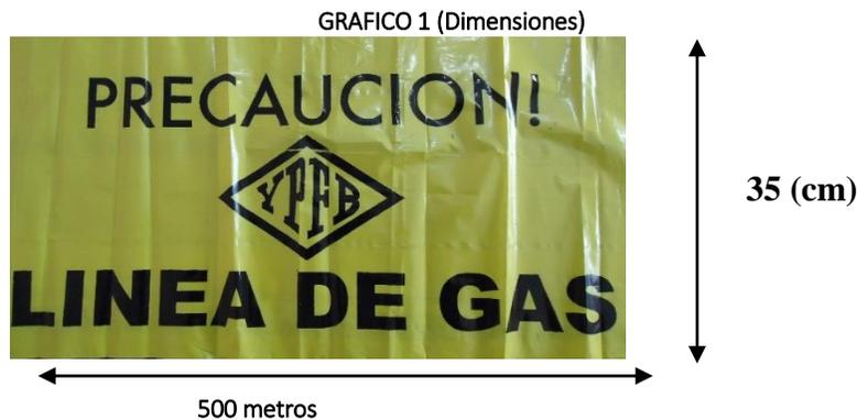
La cinta de señalización debe ser ubicada 30 cm por debajo del nivel del suelo, sobre una superficie compactada y plana y la misma quedará centrada con respecto al eje longitudinal de la zanja, la cinta deberá indicar "PRECAUCIÓN – LÍNEA DE GAS"
