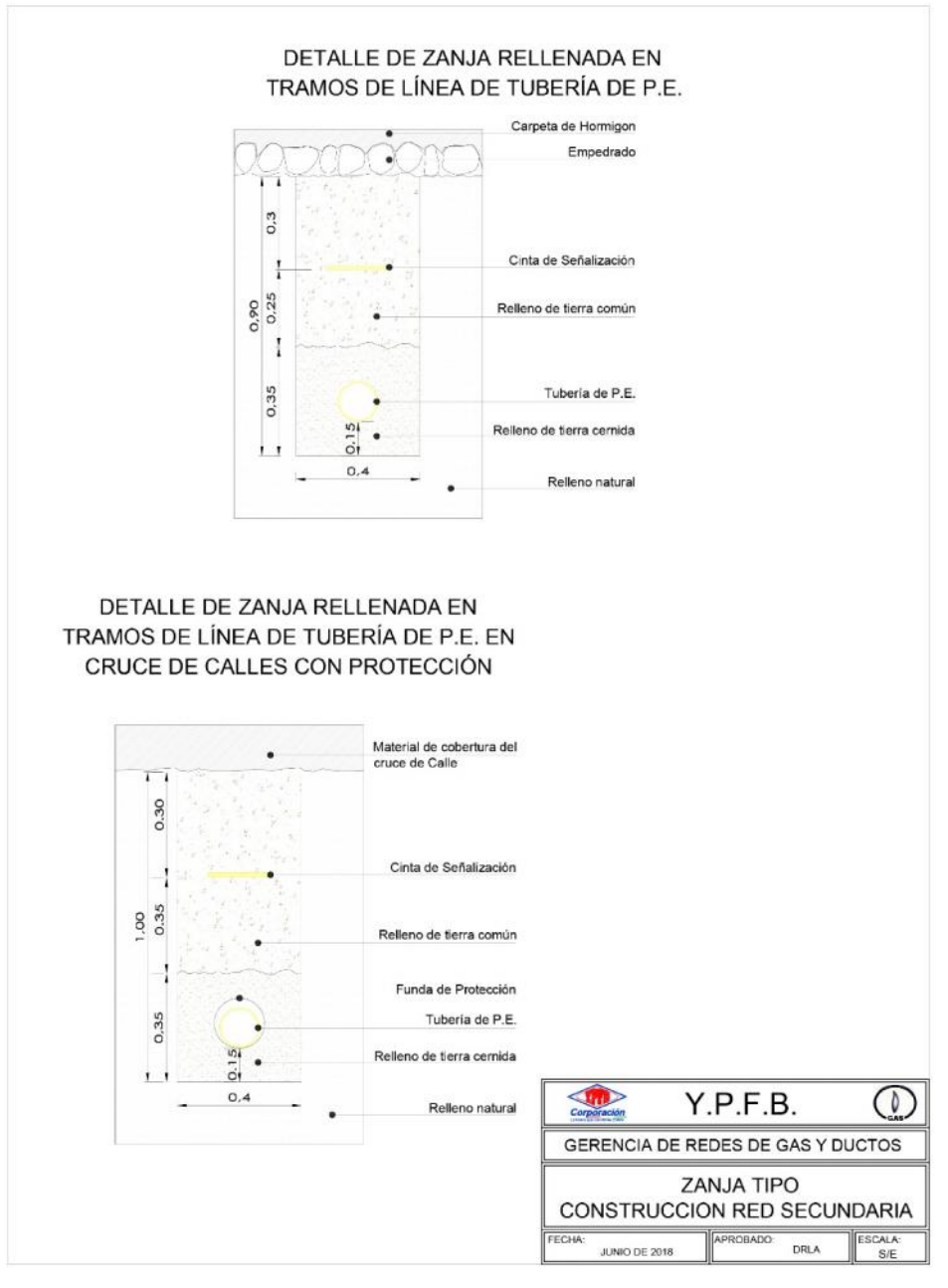
FIGURA 3. ZANJA TIPO CONSTRUCCIÓN RED SECUNDARIA
