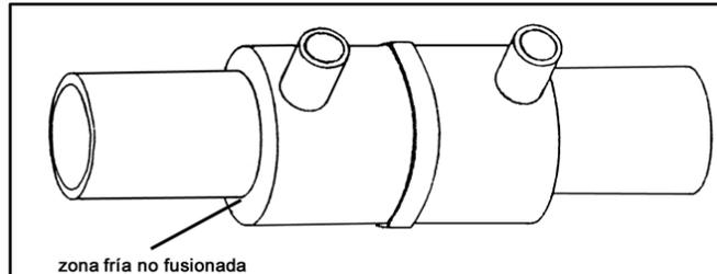
**8.2. INCORRECTA UNIÓN A ENCHUFE POR *ELECTROFUSIÓN***
