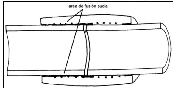
Figura 5. Alineación defectuosa.
