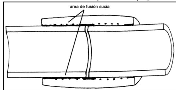
Figura 5. Alineación defectuosa.
