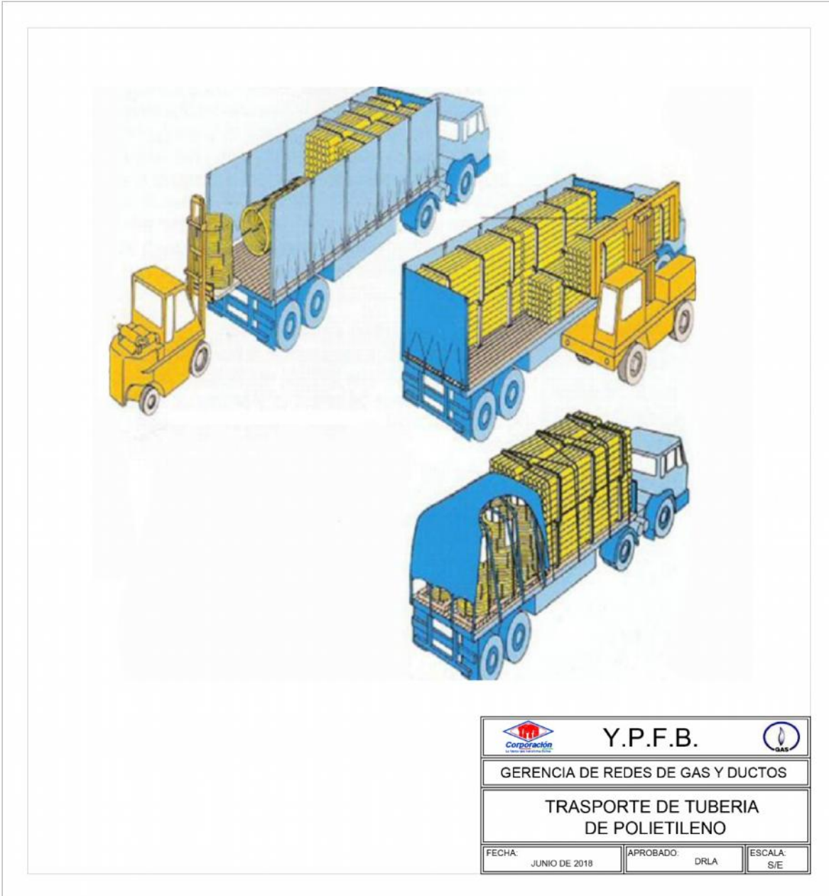
FIGURA 2. TRANSPORTE Y MANIPULACIÓN DE TUBERÍA DE POLIETILENO
