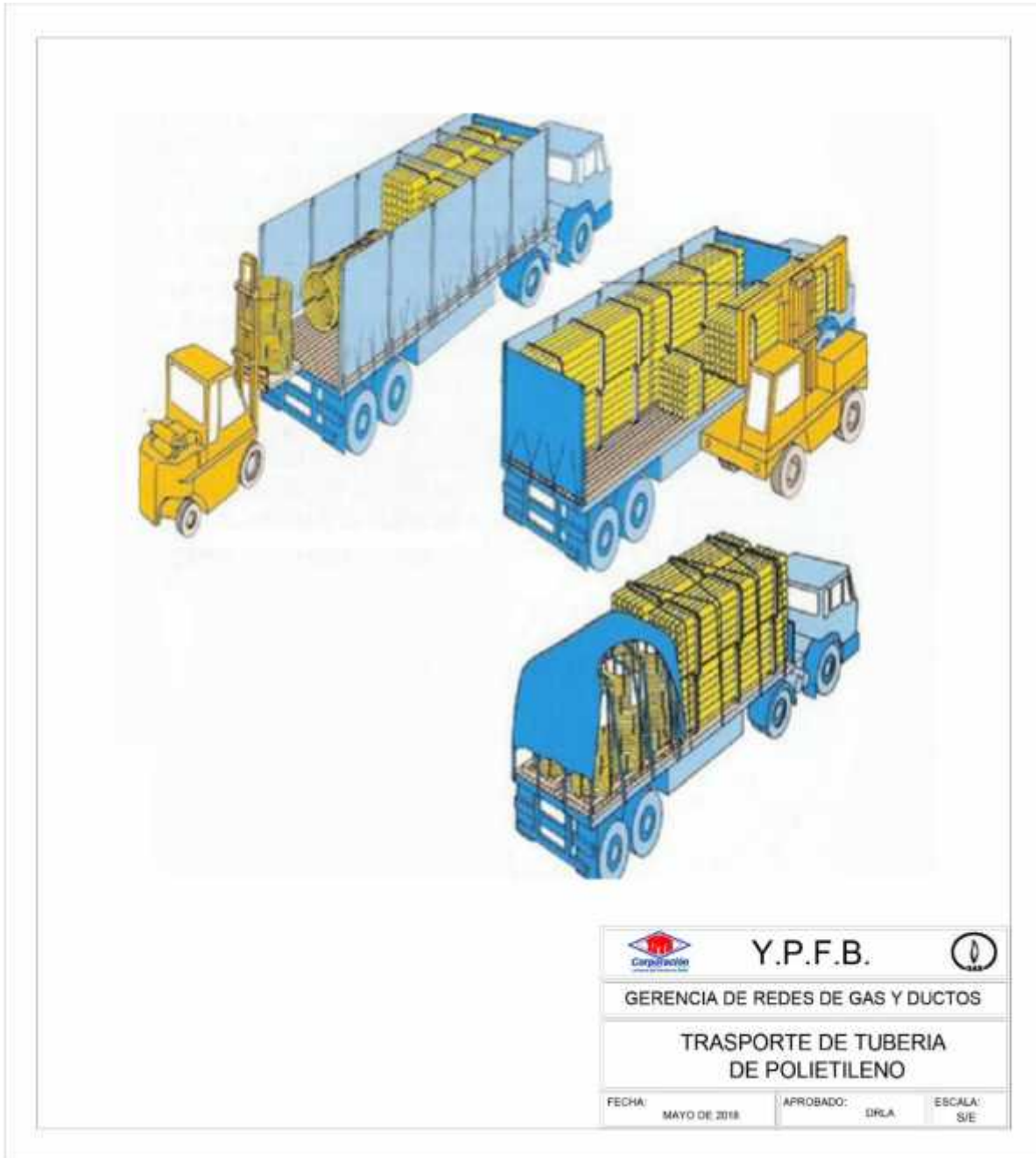
FIGURA 2. TRANSPORTE Y MANIPULACIÓN DE TUBERÍA DE POLIETILENO
