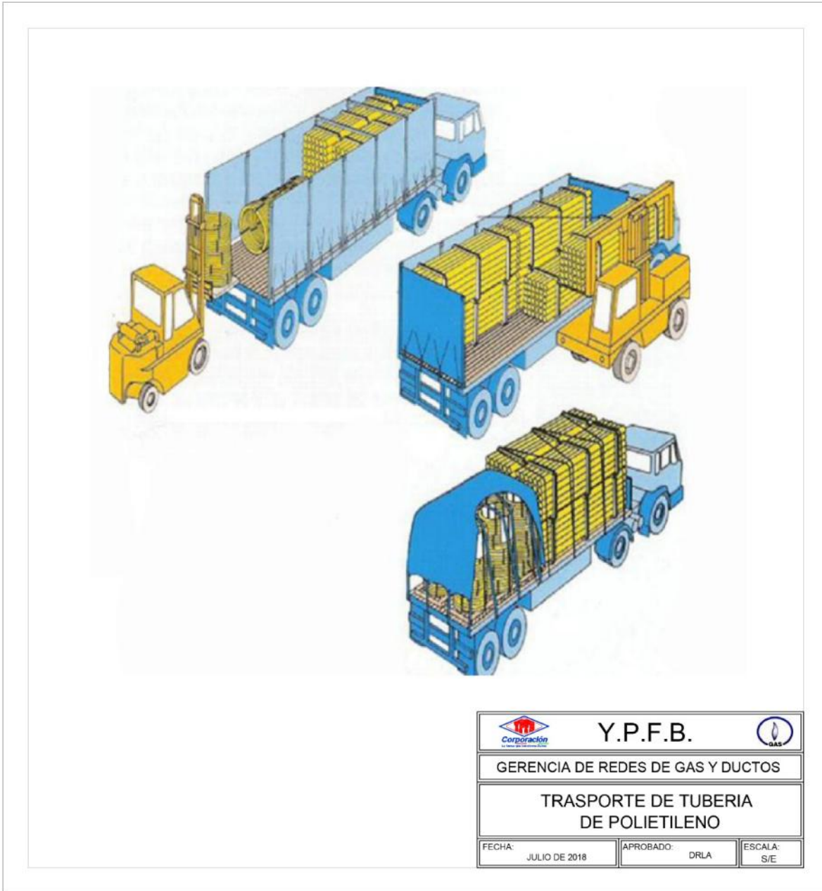
FIGURA 2. TRANSPORTE Y MANIPULACIÓN DE TUBERÍA DE POLIETILENO
