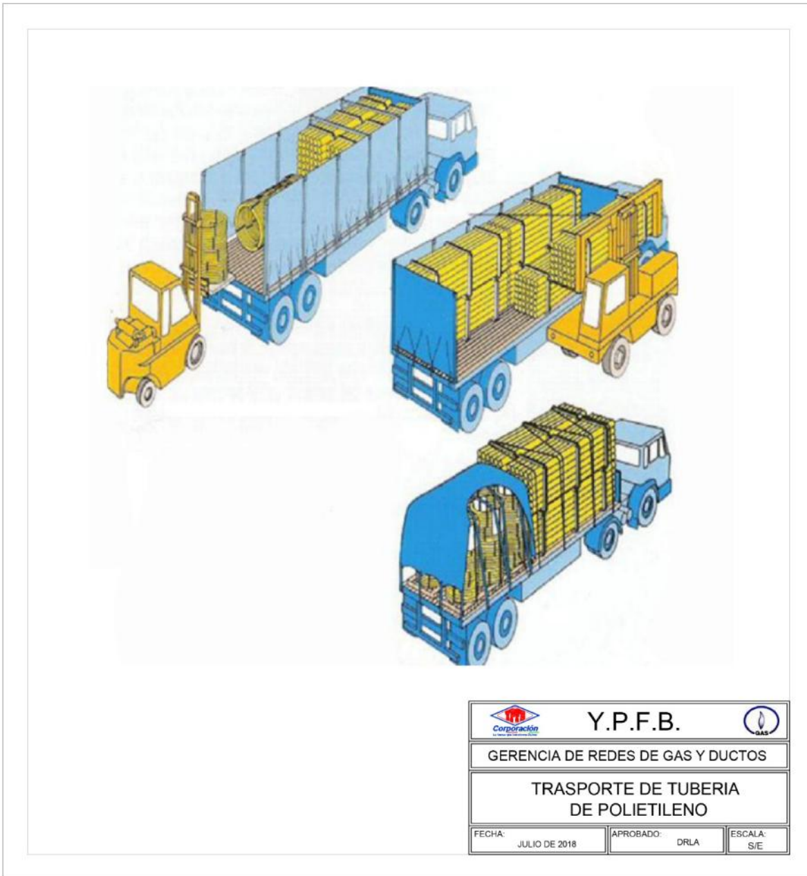
FIGURA 2. TRANSPORTE Y MANIPULACIÓN DE TUBERÍA DE POLIETILENO
