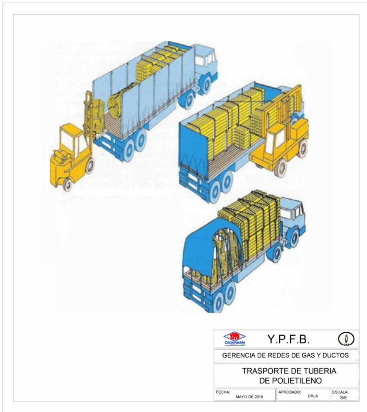
FIGURA 2. TRANSPORTE Y MANIPULACIÓN DE TUBERÍA DE POLIETILENO
