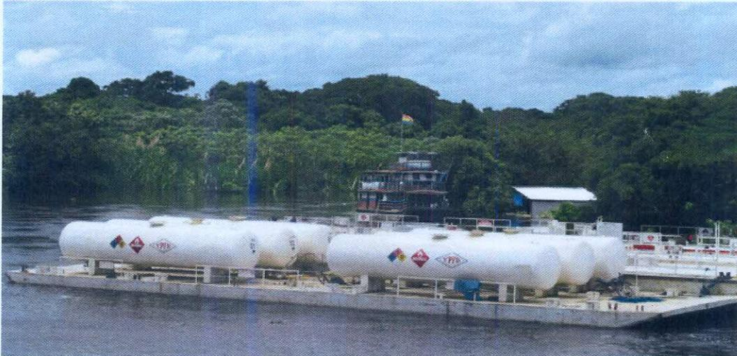
**TANQUES DE ALTA PRESION DE ALMACENAMIENTO DE GLP**
