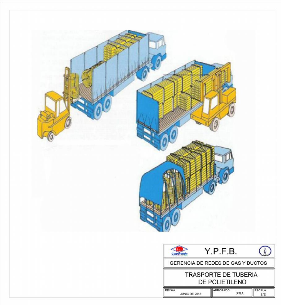
FIGURA 2. TRANSPORTE Y MANIPULACIÓN DE TUBERÍA DE POLIETILENO
