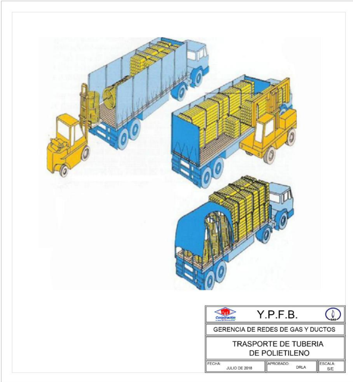
FIGURA 2. TRANSPORTE Y MANIPULACIÓN DE TUBERÍA DE POLIETILENO
