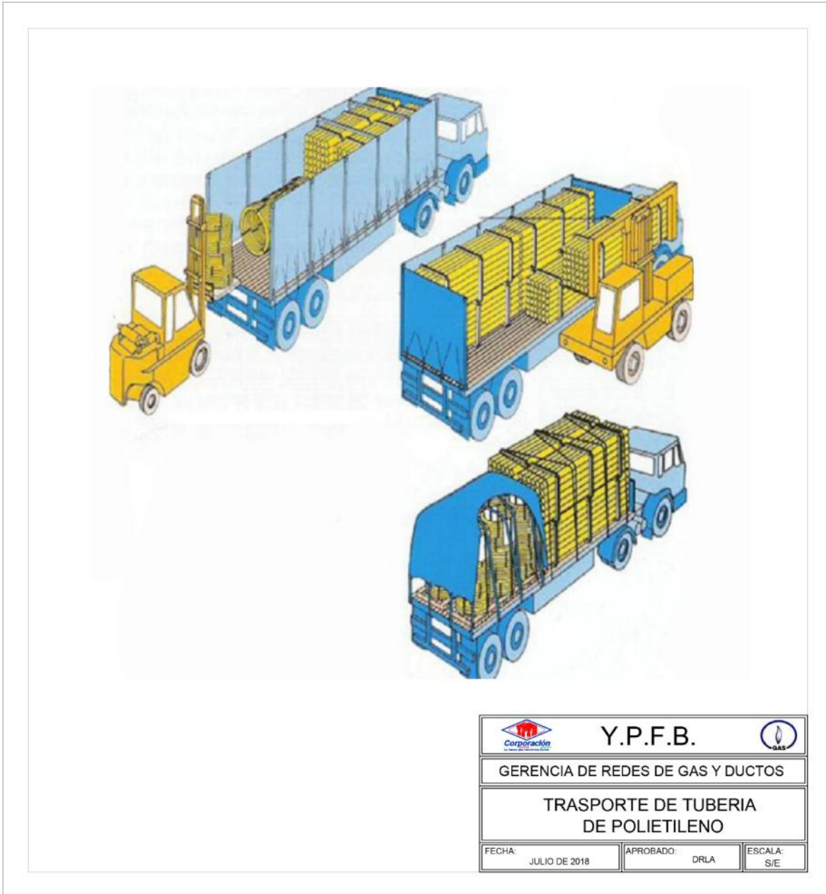
FIGURA 2. TRANSPORTE Y MANIPULACIÓN DE TUBERÍA DE POLIETILENO
