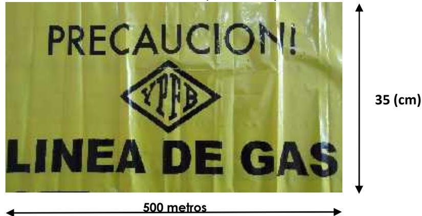
La cinta de señalización debe ser ubicada 30 cm antes del nivel superior de la zanja indicando “PRECAUCIÓN – LÍNEA DE GAS”
