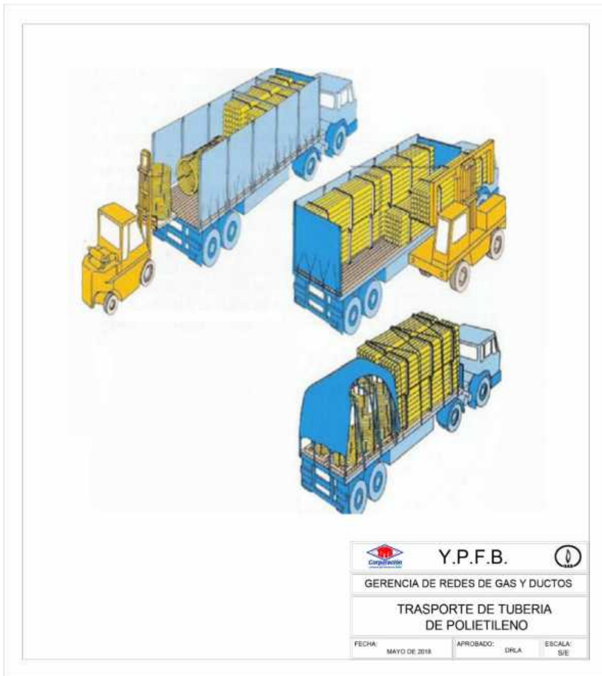
FIGURA 2. TRANSPORTE Y MANIPULACIÓN DE TUBERÍA DE POLIETILENO
