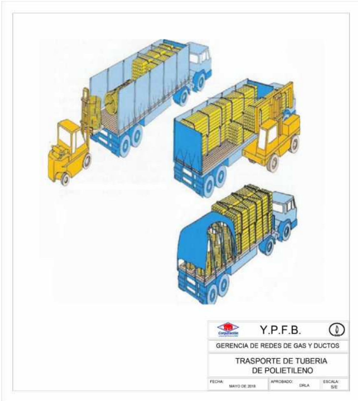
FIGURA 2. TRANSPORTE Y MANIPULACIÓN DE TUBERÍA DE POLIETILENO
