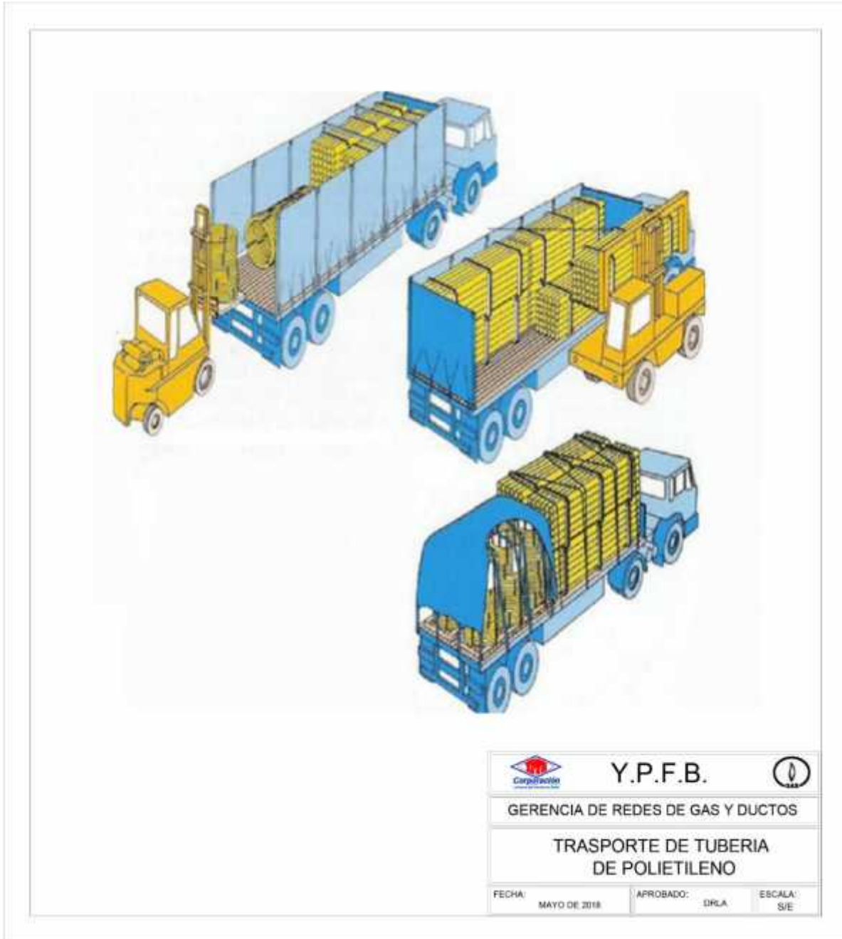
FIGURA 2. TRANSPORTE Y MANIPULACIÓN DE TUBERÍA DE POLIETILENO
