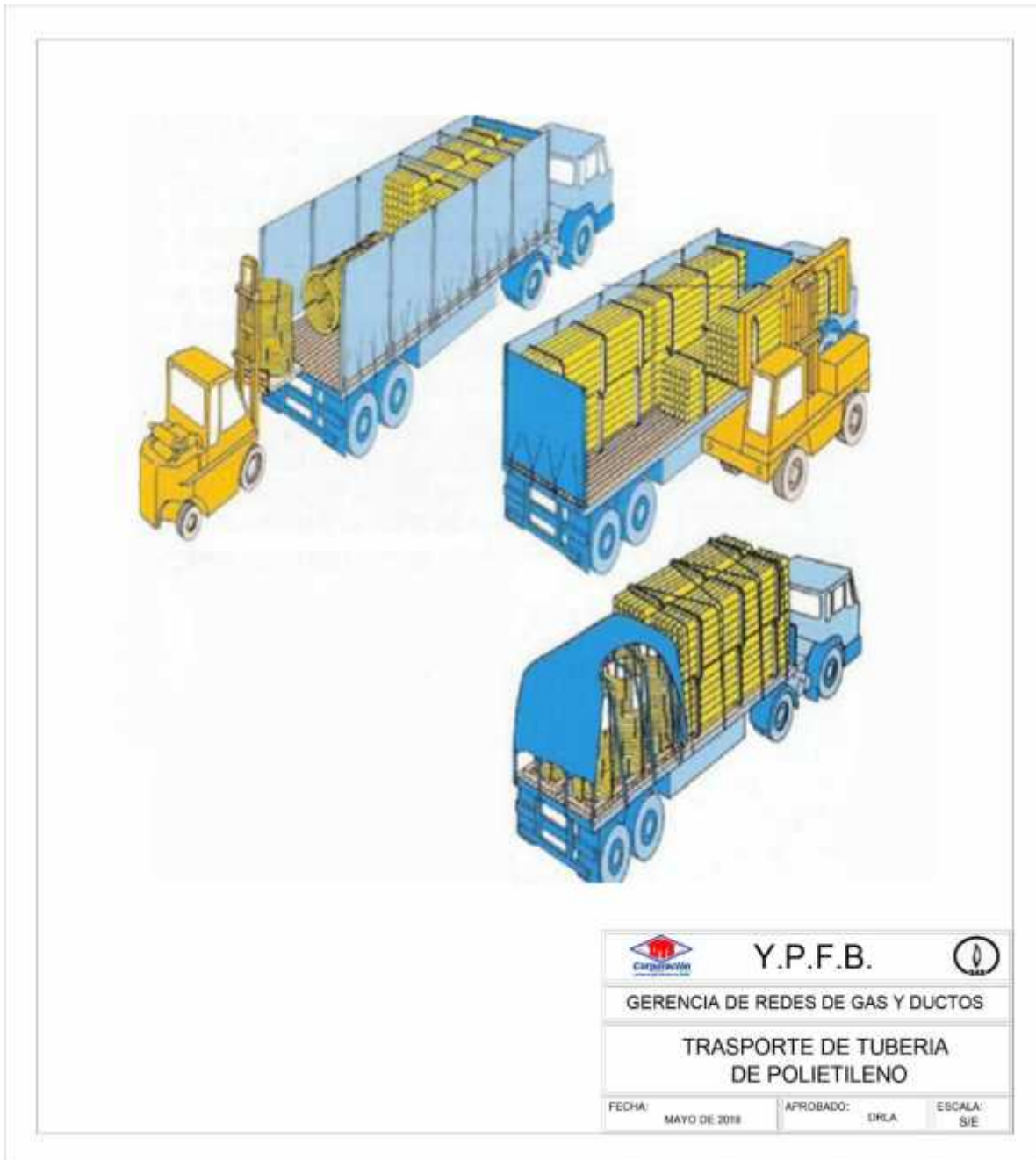
FIGURA 2. TRANSPORTE Y MANIPULACIÓN DE TUBERÍA DE POLIETILENO
