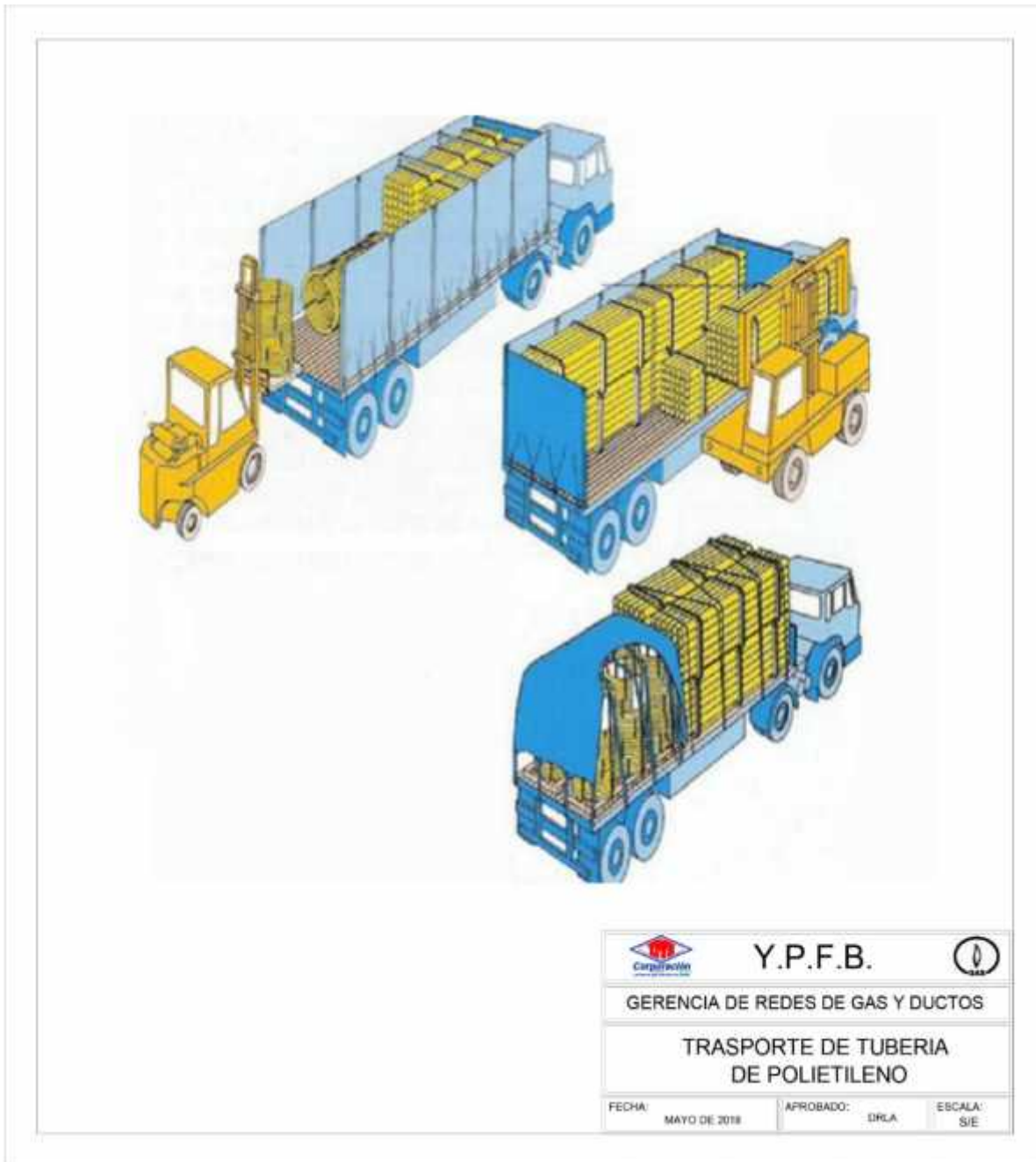
FIGURA 2. TRANSPORTE Y MANIPULACIÓN DE TUBERÍA DE POLIETILENO
