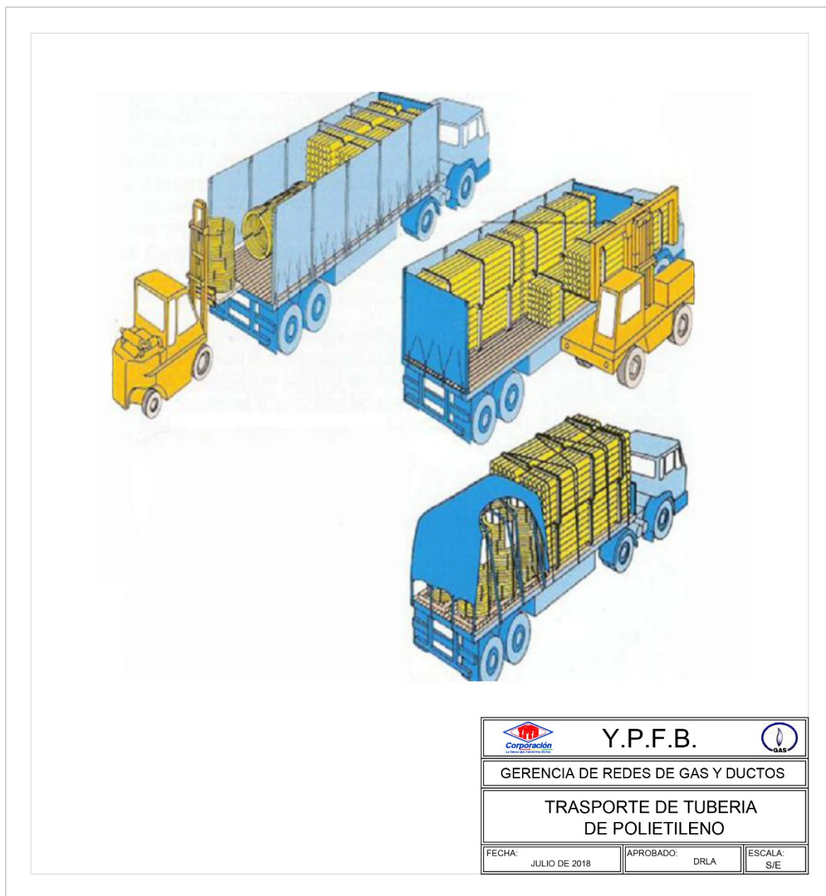
FIGURA 2. TRANSPORTE Y MANIPULACIÓN DE TUBERÍA DE POLIETILENO
