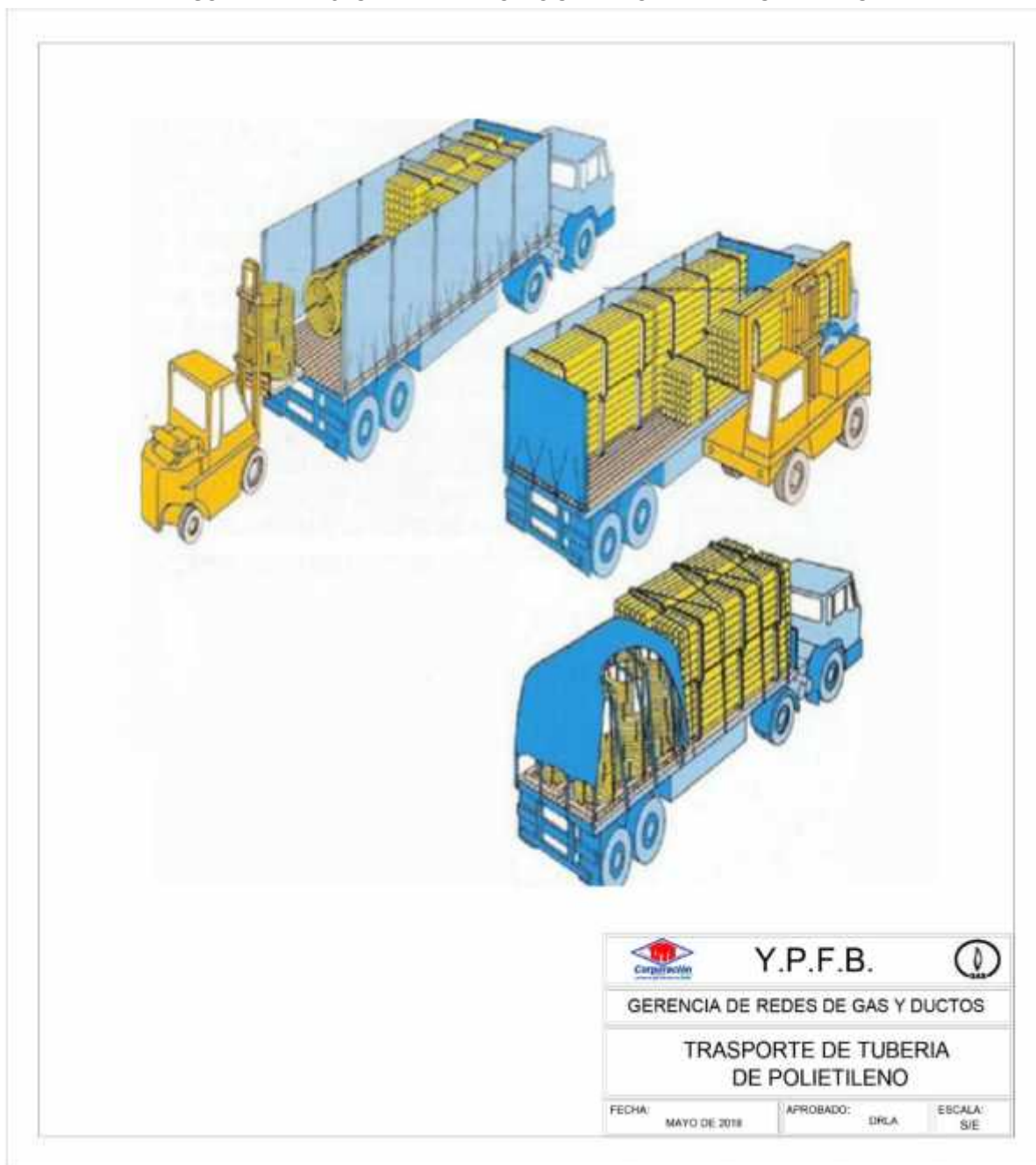
FIGURA 2. TRANSPORTE Y MANIPULACIÓN DE TUBERÍA DE POLIETILENO
