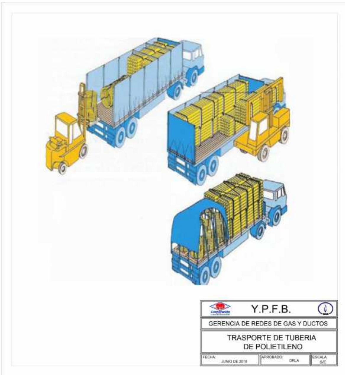
FIGURA 2. TRANSPORTE Y MANIPULACIÓN DE TUBERÍA DE POLIETILENO
