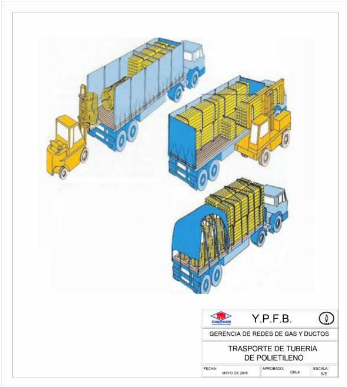
FIGURA 2. TRANSPORTE Y MANIPULACIÓN DE TUBERÍA DE POLIETILENO
