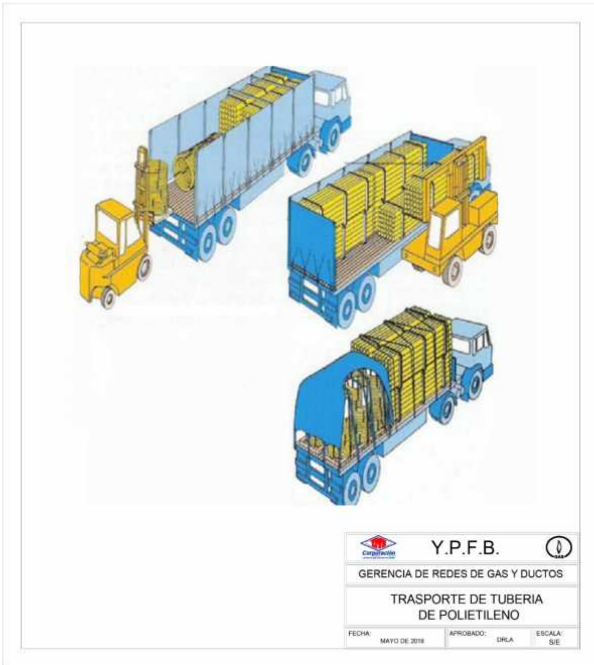
FIGURA 2. TRANSPORTE Y MANIPULACIÓN DE TUBERÍA DE POLIETILENO
