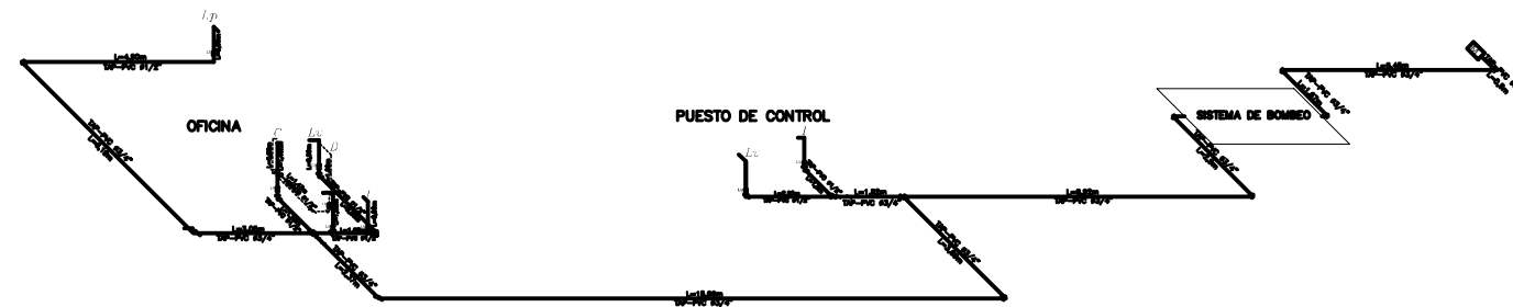
ISOMÉTRICO AGUA POTABLE FRIA Y CALIENTE ESC. 1:100
