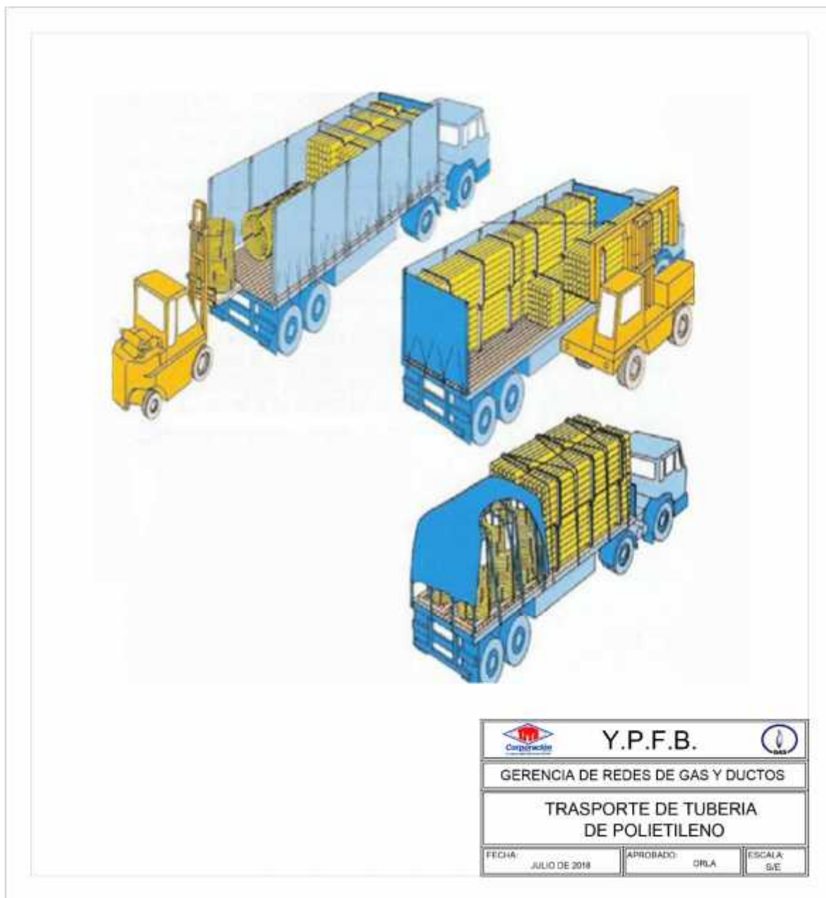
FIGURA 2. TRANSPORTE Y MANIPULACIÓN DE TUBERÍA DE POLIETILENO
