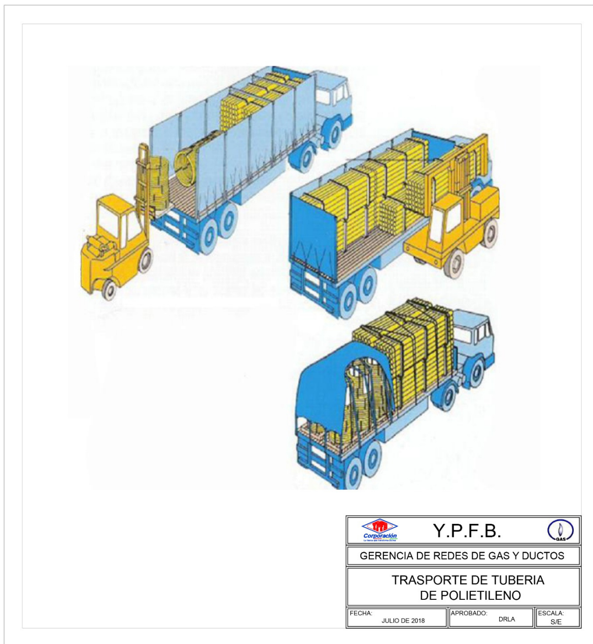
FIGURA 2. TRANSPORTE Y MANIPULACIÓN DE TUBERÍA DE POLIETILENO
