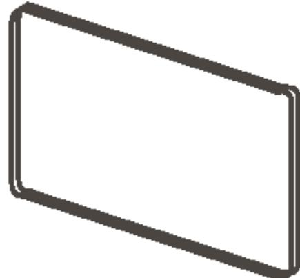
Instalación del visor, se debe ajustar el soporte del visor en sus cuatro extremos para que este no sea removido con facilidad, como se muestra en la siguiente figura. Adhiriendo alrededor del borde interior del visor de la puerta con silicona para hacerlo impermeable.
