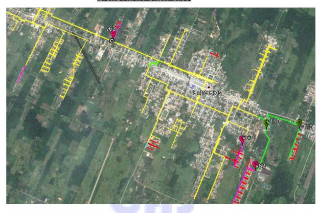
TUBERÍA DE PE 110 mm
