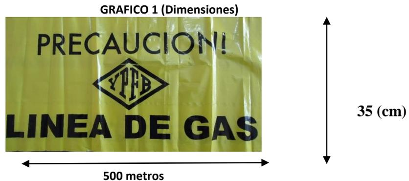
La cinta de señalización debe ser ubicada 30 cm antes del nivel superior de la zanja indicando "PRECAUCIÓN"
