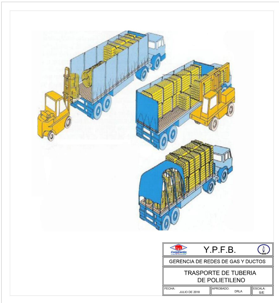
FIGURA 2. TRANSPORTE Y MANIPULACIÓN DE TUBERÍA DE POLIETILENO
