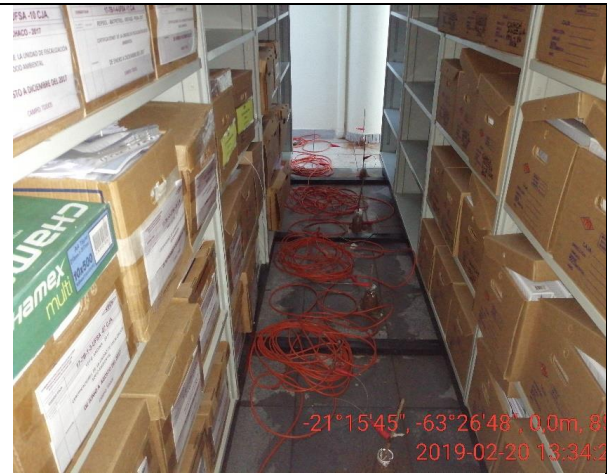
Fotos 3 y 4: se observa la línea del tendido de cables y electrodos de la L1 en el laboratorio y su final en el archivo.
