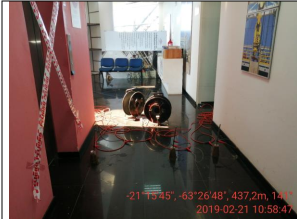
Foto 10 y 11: se observa el tendido de la L3 dentro del edificio, antes y después del ascensor.
