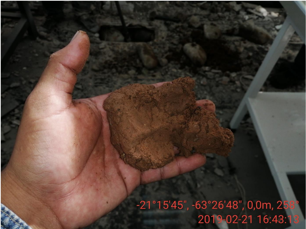
Foto 17: muestra de suelo o barro denso de limo-areno-arcilloso, con algunos granos de roca, sacado con la vizcachera a 1.0 m de profundidad. El suelo se observaba con más humedad hacia abajo.
