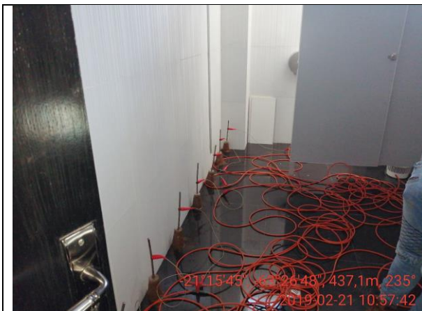
Fotos 8 y 9: se observa el tendido dentro del edificio empezando del baño (foto derecha) y luego en los pasillos. Para esta línea, para evitar distorsión, se empleó un equipo de topografía para en-rectar la línea con la de afuera del edificio.
