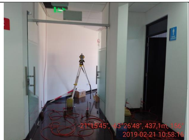
Fotos 8 y 9: se observa el tendido dentro del edificio empezando del baño (foto derecha) y luego en los pasillos. Para esta línea, para evitar distorsión, se empleó un equipo de topografía para en-rectar la línea con la de afuera del edificio.
