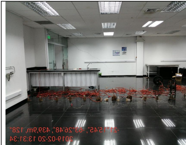
Fotos 3 y 4: se observa la línea del tendido de cables y electrodos de la L1 en el laboratorio y su final en el archivo.
