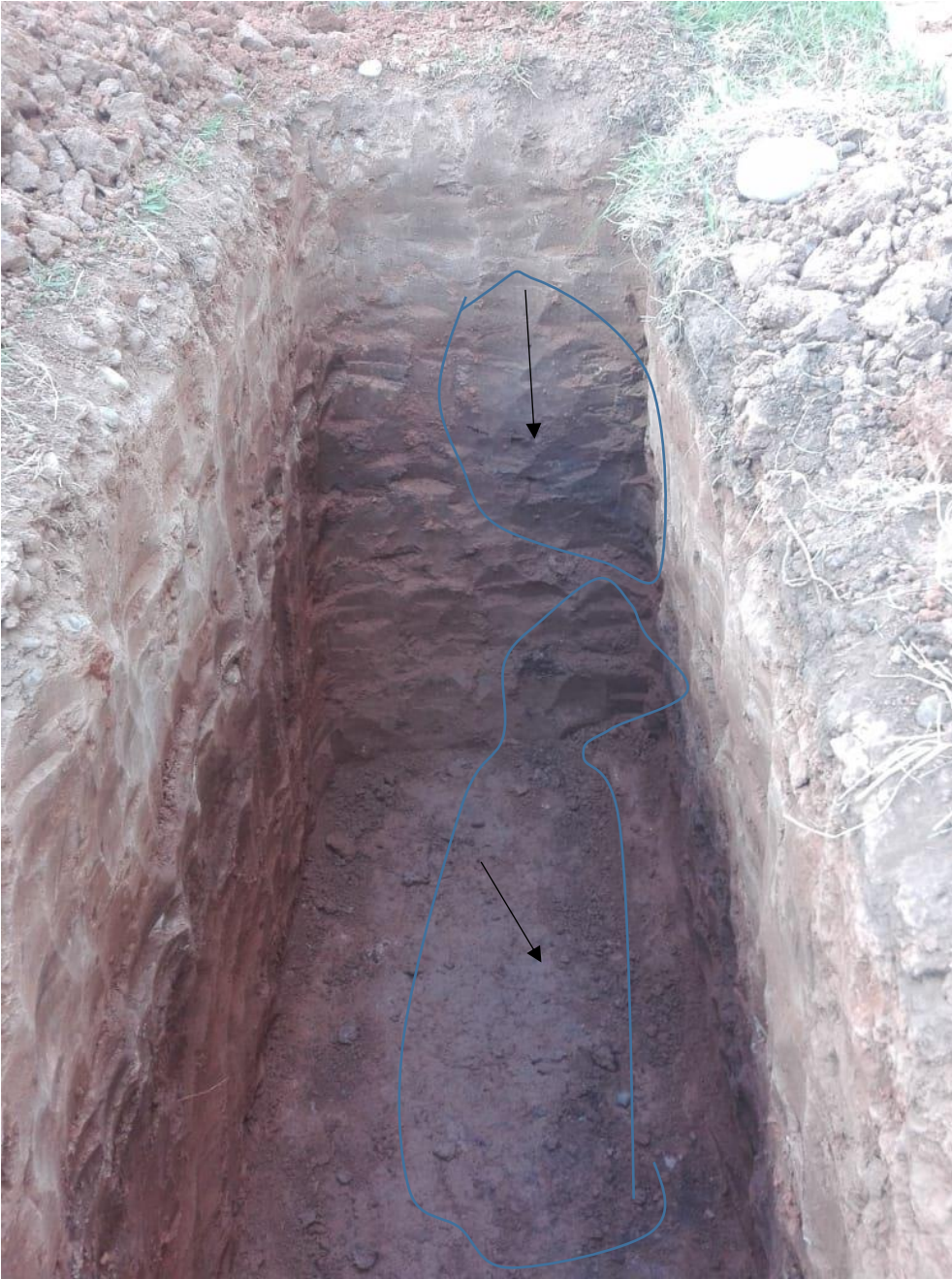
Foto 19: se observa la calicata de 1.0 m de profundidad constituido por limo-arcilla, con más porcentaje que el anterior de arcilla. Se observa una coloración oscura de arcilla con materia orgánica indicado por la flecha negra.
