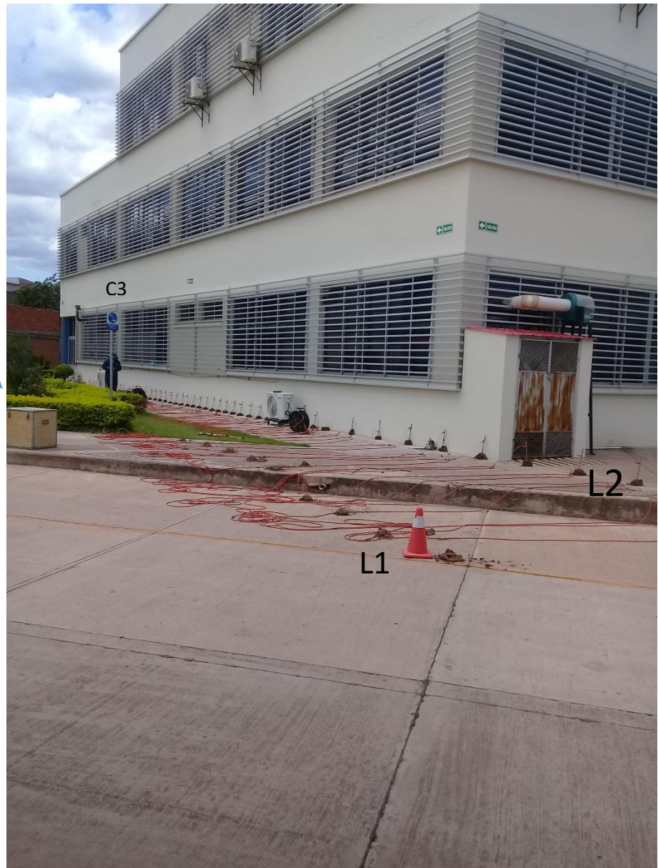
Foto 1 se observa la posición de las dos tomografías L1 y L2. Y a un costado la foto de una cámara rebalsando de agua, como el suelo saturado de agua también.
