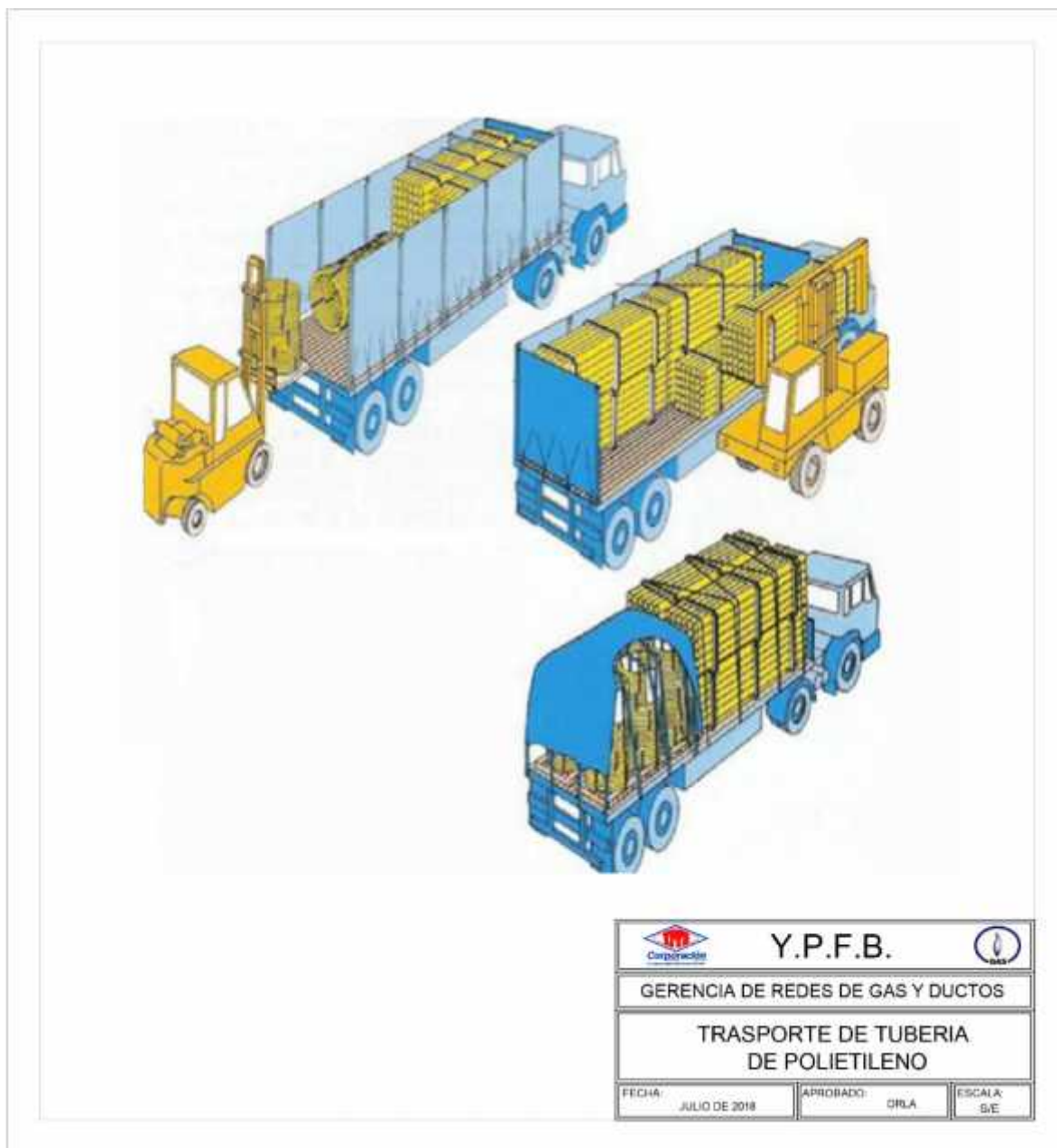
FIGURA 2. TRANSPORTE Y MANIPULACIÓN DE TUBERÍA DE POLIETILENO
