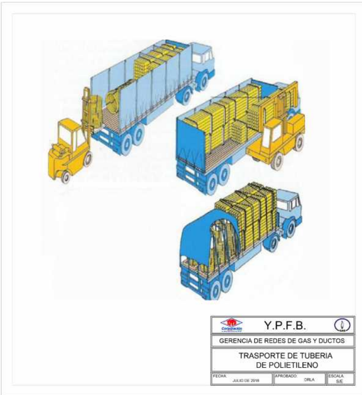
FIGURA 2. TRANSPORTE Y MANIPULACIÓN DE TUBERÍA DE POLIETILENO
