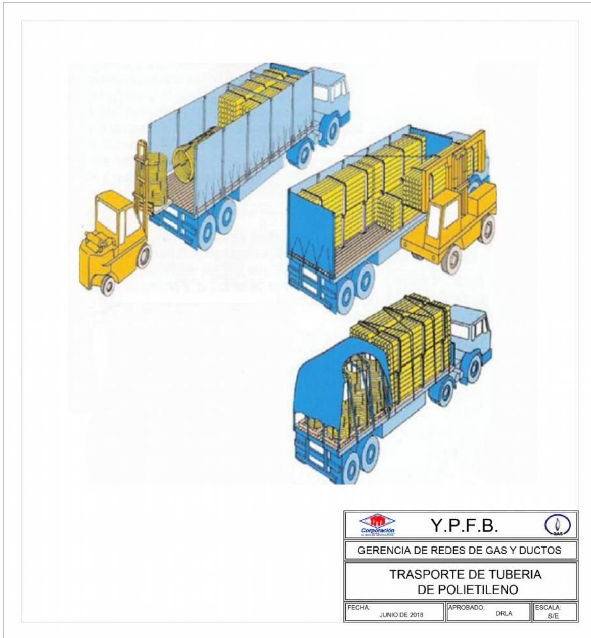
FIGURA 2. TRANSPORTE Y MANIPULACIÓN DE TUBERÍA DE POLIETILENO
