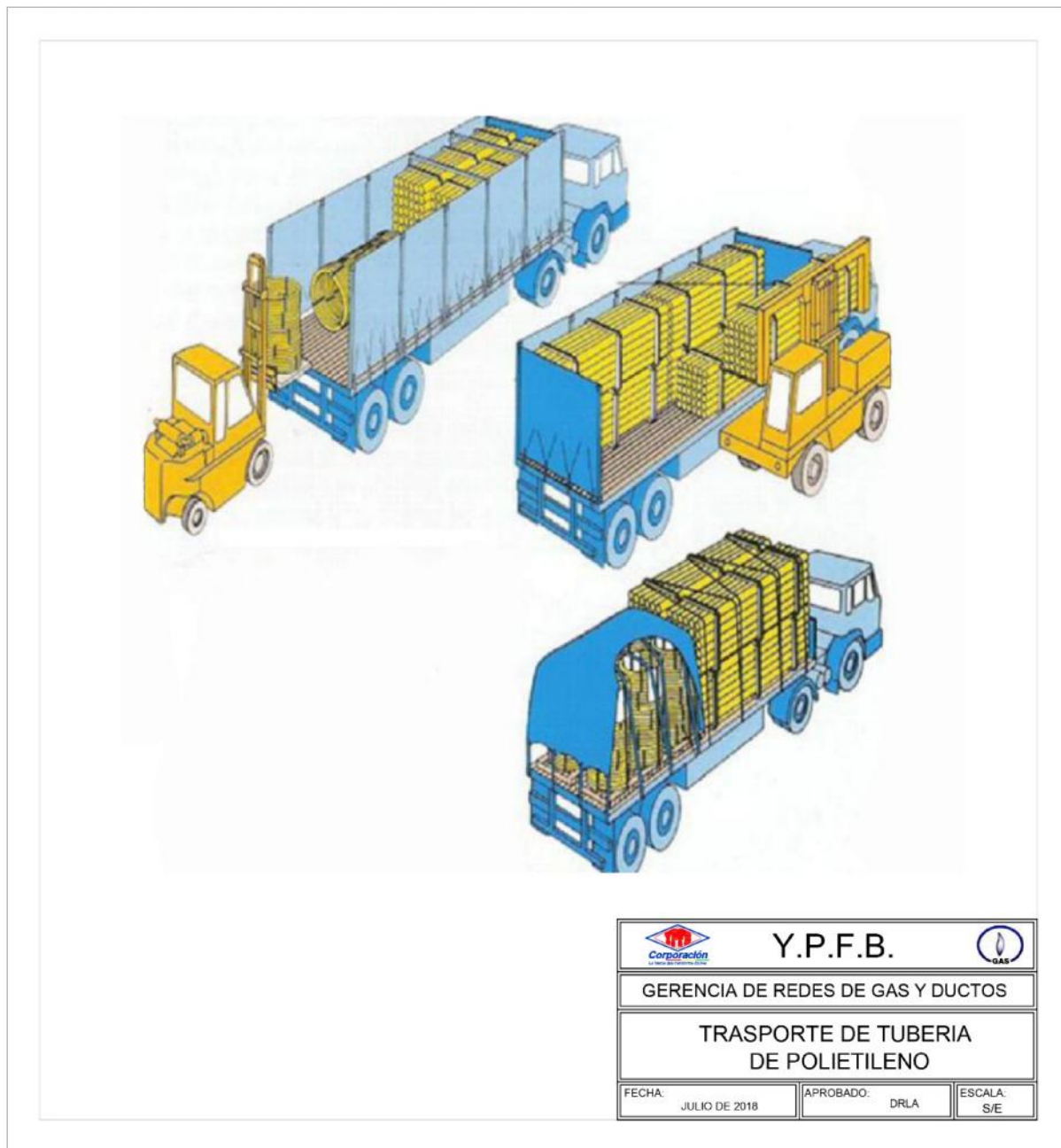
FIGURA 2. TRANSPORTE Y MANIPULACIÓN DE TUBERÍA DE POLIETILENO
