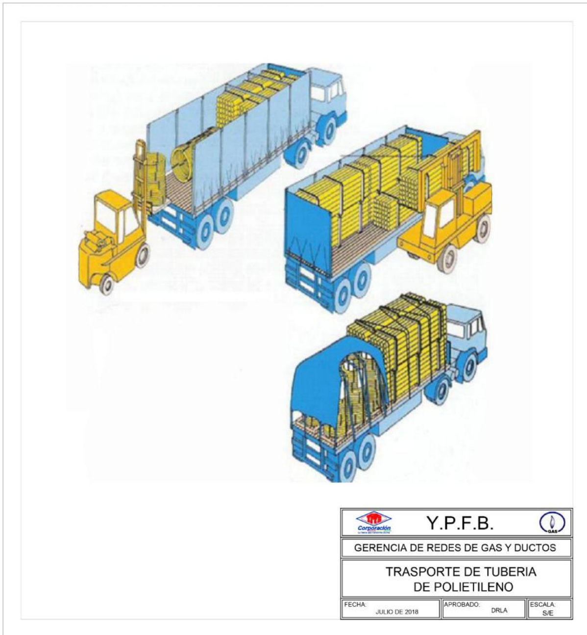
FIGURA 2. TRANSPORTE Y MANIPULACIÓN DE TUBERÍA DE POLIETILENO
