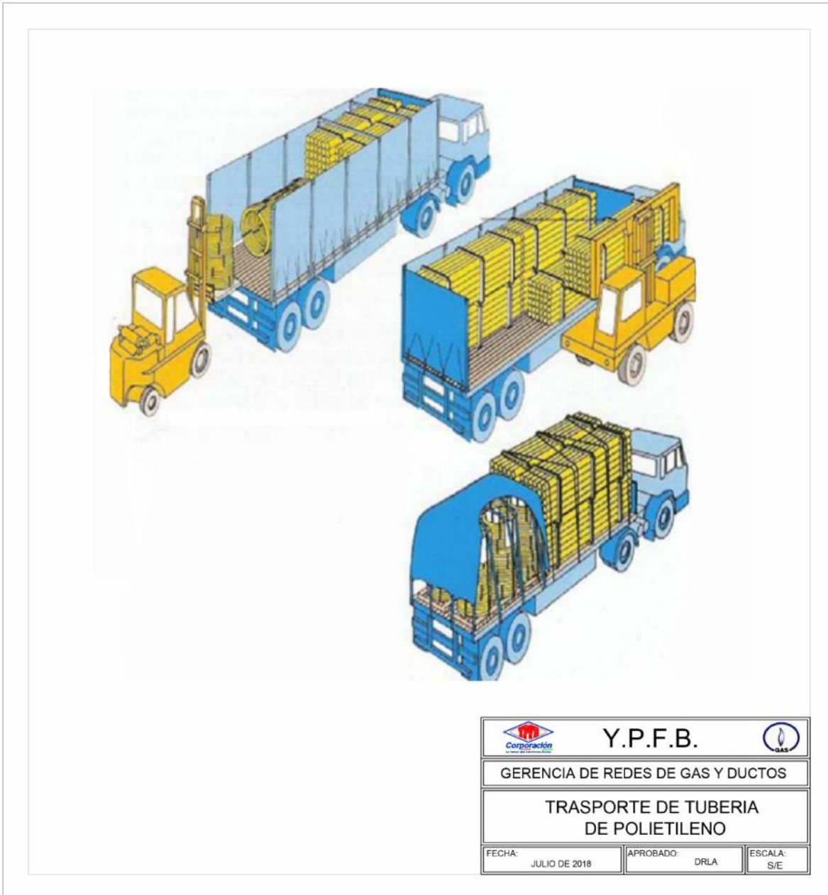
FIGURA 2. TRANSPORTE Y MANIPULACIÓN DE TUBERÍA DE POLIETILENO
