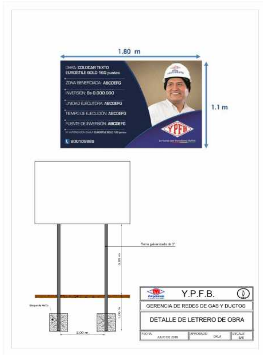
FIGURA 1. LETRERO DE OBRA
