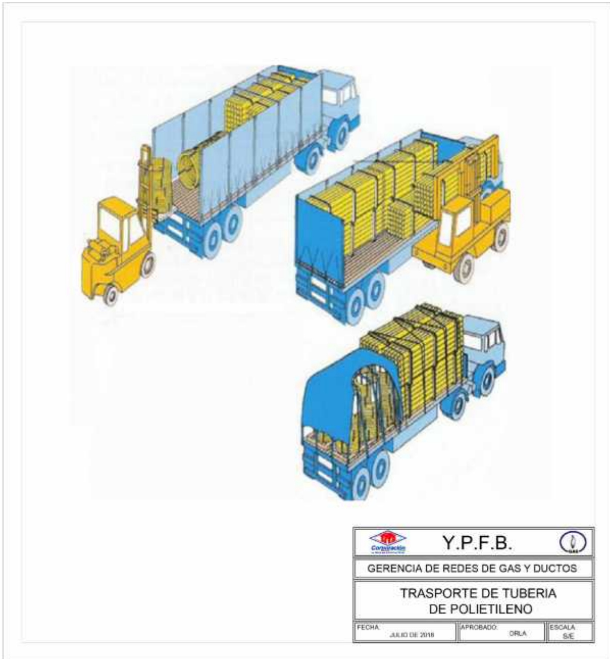
FIGURA 2. TRANSPORTE Y MANIPULACIÓN DE TUBERÍA DE POLIETILENO
