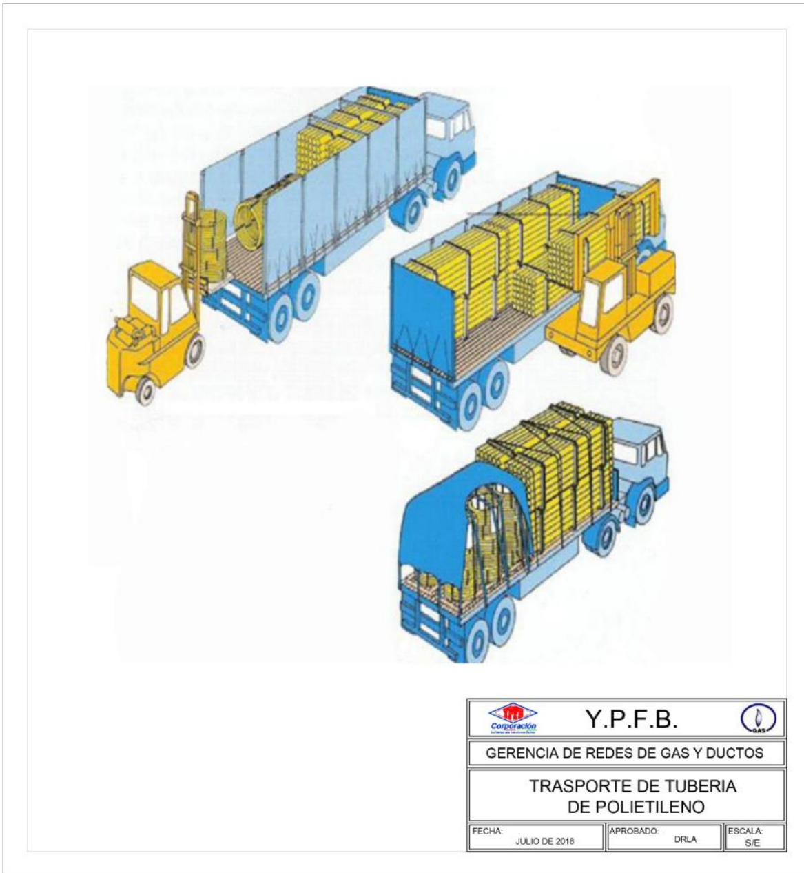
FIGURA 2. TRANSPORTE Y MANIPULACIÓN DE TUBERÍA DE POLIETILENO
