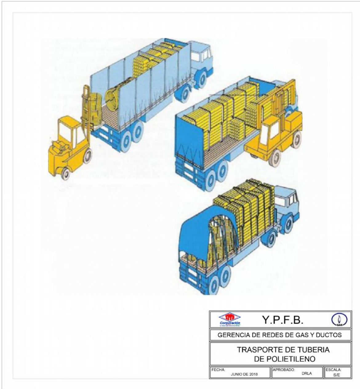
FIGURA 2. TRANSPORTE Y MANIPULACIÓN DE TUBERÍA DE POLIETILENO
