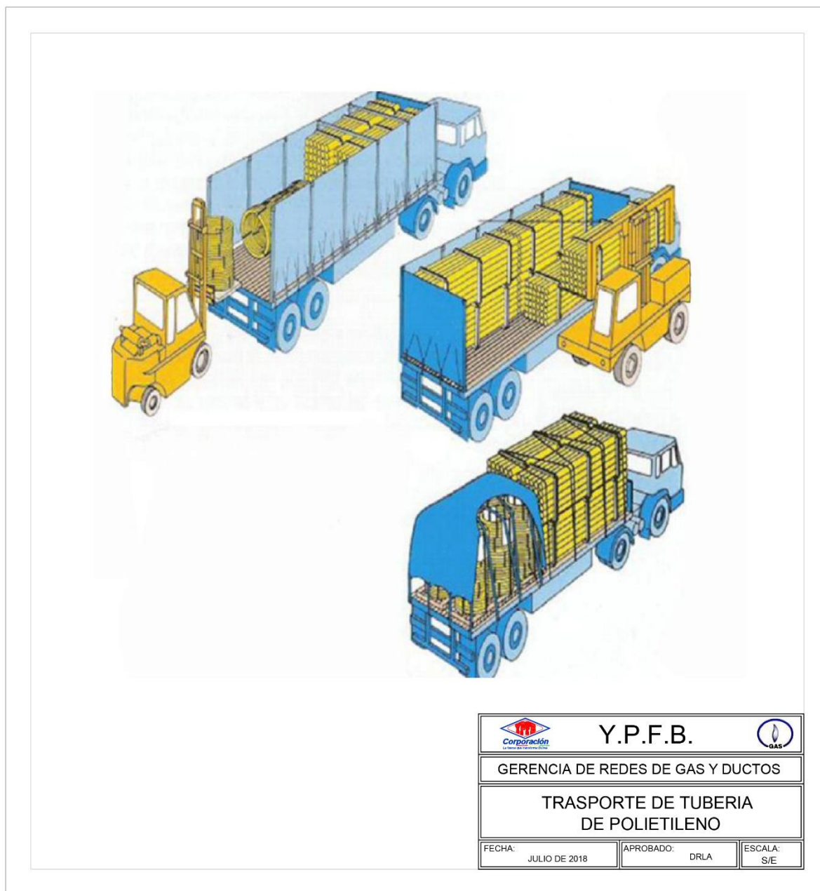
FIGURA 2. TRANSPORTE Y MANIPULACIÓN DE TUBERÍA DE POLIETILENO
