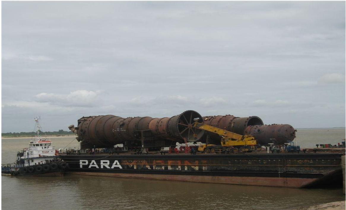
Figura 3.4.51 Ejemplo de transporte de equipos en barcazas o gabarras. “Fuente: Información Pública”.
