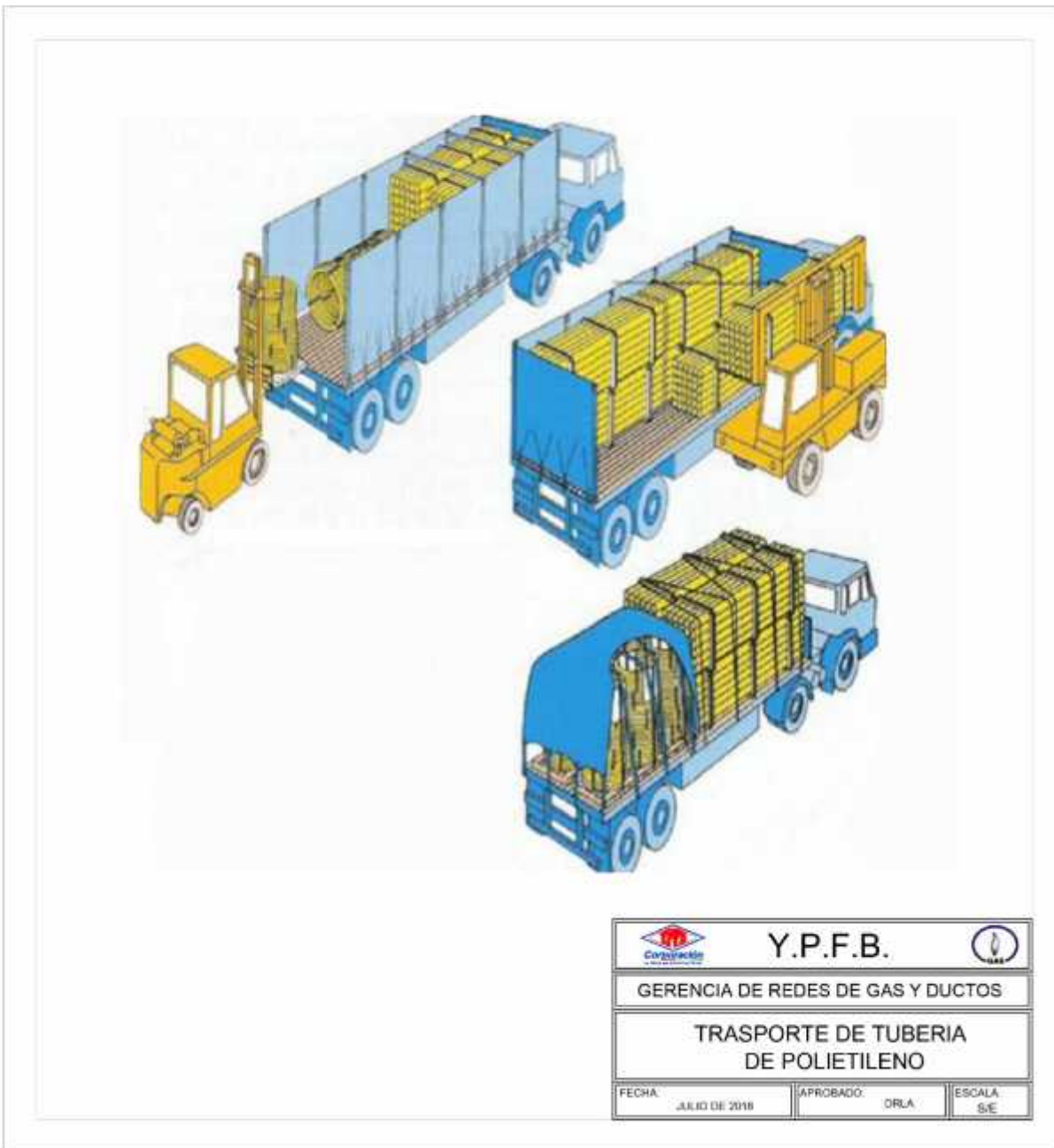
FIGURA 2. TRANSPORTE Y MANIPULACIÓN DE TUBERÍA DE POLIETILENO
