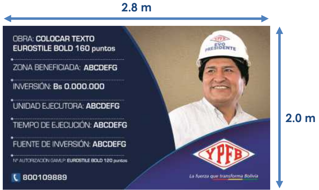
FIGURA 1. LETRERO DE OBRA
