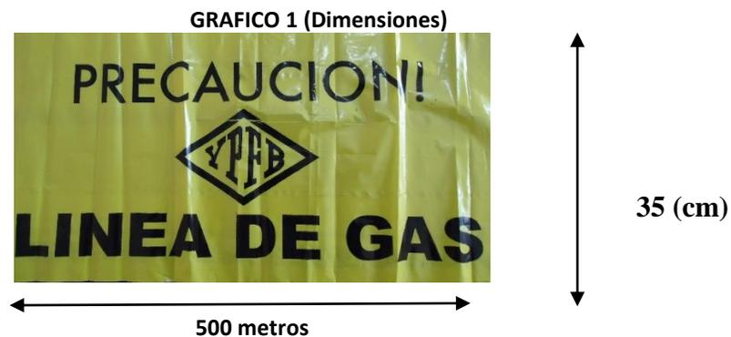
La cinta de señalización debe ser ubicada 30 cm antes del nivel superior de la zanja indicando "PRECAUCIÓN – LÍNEA DE GAS"
